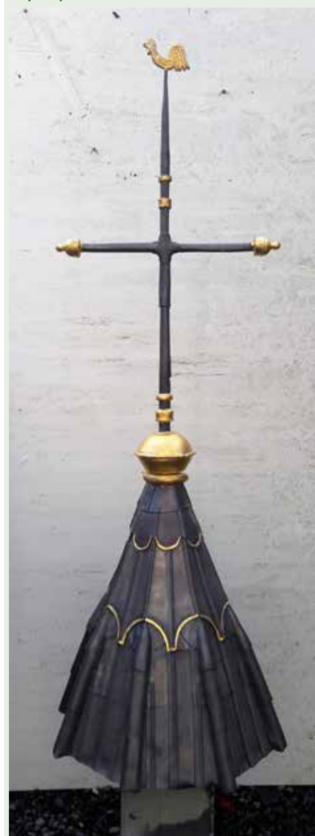
Tournai, cathédrale Notre-Dame, partie sommitale de la tour-lanterne. Afin de vérifier la modénature et les assemblages des tables de plomb coulé sur sable, une maquette a été réalisée en cours de chantier à l'échelle 1/10. Il ne s'agit donc pas dans le cas présent de sélectionner une entreprise mais de vérifier la faisabilité de certaines propositions techniques © SPW
