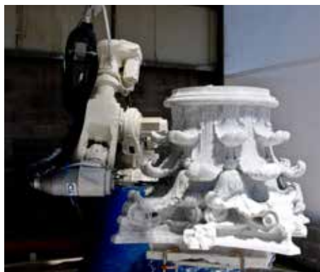
Taille d'un chapiteau corinthien par un robot © T&D Robotics
