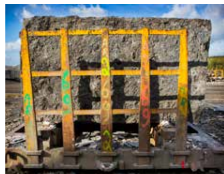
Connaissances approfondies du matériau « pierre » et techniques de réception. Tranches de pierre bleue à réceptionner © G. DELHALLE
