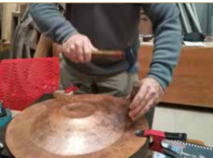
Réalisation d'une pièce avec la technique du battage – Formateur : J. D'Haegheleer – © AWaP
