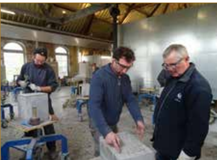
Dressage du bloc de pierre bleue et réalisation de la palette – Formateur : C. Mahy – © AWaP
