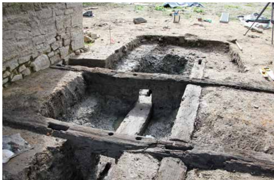
Traverses en bois des passerelles des XIII e et XVI e retrouvées dans la vase sous le pont de pierre © GdG architects
