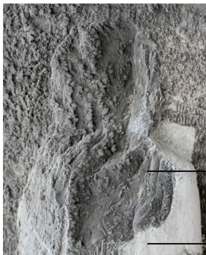
Fig. 35 Détail des couches de peinture qui s'arrêtent net au bord du plan de fracture (Porte du Capitole).
