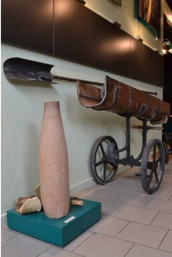
Condenseur en terre cuite, creuset en terre crue, conservé dans son chariot, et présenté dans la salle des métaux non ferreux à côté d'une cuillère de chargement © MMIL
