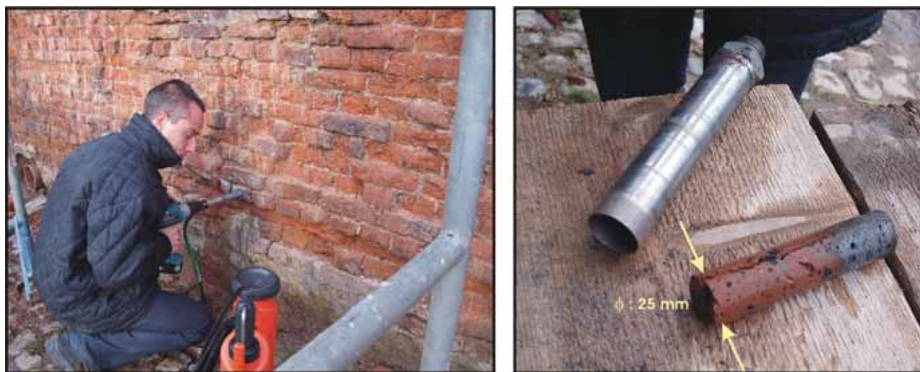
Figure 2 : (Voir planche couleur) Échantillonnage de briques par carottage en petit diamètre avec une machine portable dans les murs de la Ferme de l'Abbaye de Neufvilles (Belgique) à gauche, et exemple d'un prélèvement à droite.
