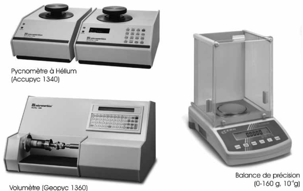
Figure 5 : Illustration des équipements utilisés pour la détermination de la densité apparente et de la porosité ouverte.
