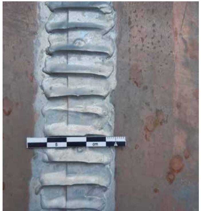
Deux tiers de la longueur de la côte se superposent au recouvrement en amont, l'autre tiers du côté aval. On appréciera également la régularité et la netteté du cordon de brasure.
